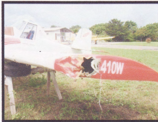
Fotografía No. 6 Vista 2 del golpe en la punta del ala
