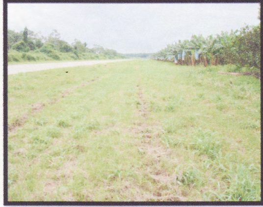
Fotografía No. 22 Vista 5 de marcas dejadas por la aeronave al salir de la pista
