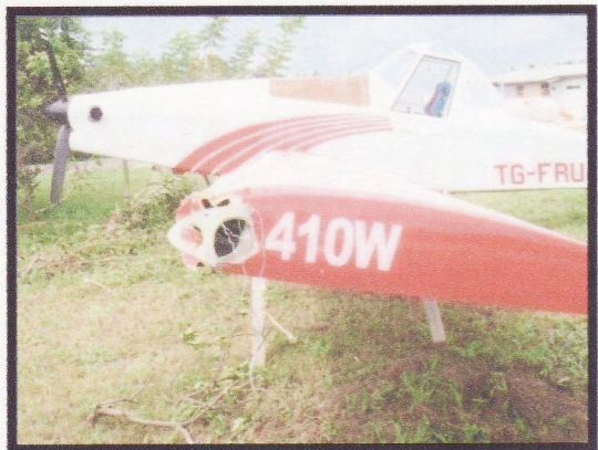
Fotografía No.5 Vista 1 del golpe en la punta del ala
