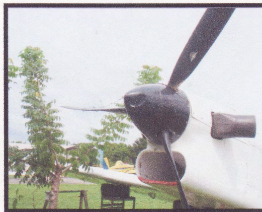
Fotografía No. 8 Vista del alambre enredado en la hélice
