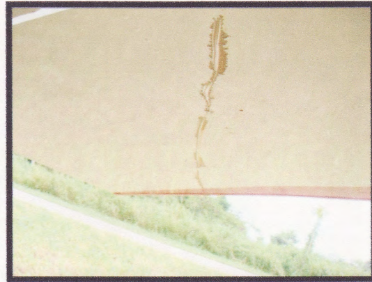
Fotografía No. 28 Vista de daño en la parte baja plano derecho de la aeronave al salir de la pista
