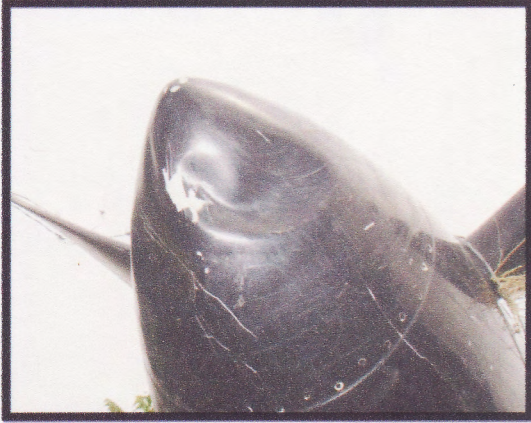
Fotografía No. 9 Vista de daños en el cobertor de la hélice
